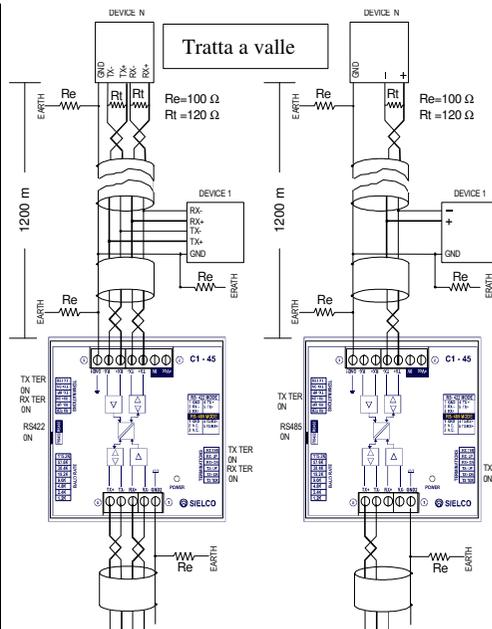
Fig. 3 - Esempio di collegamento RS422 e RS485.
